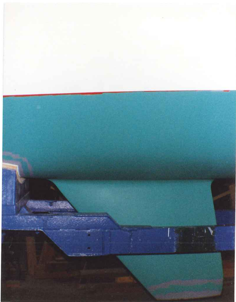
Untewasserschiff wird abgeschliffen und mit 6 Schichten Epoxidharz (Gelshield) beschichtet.
