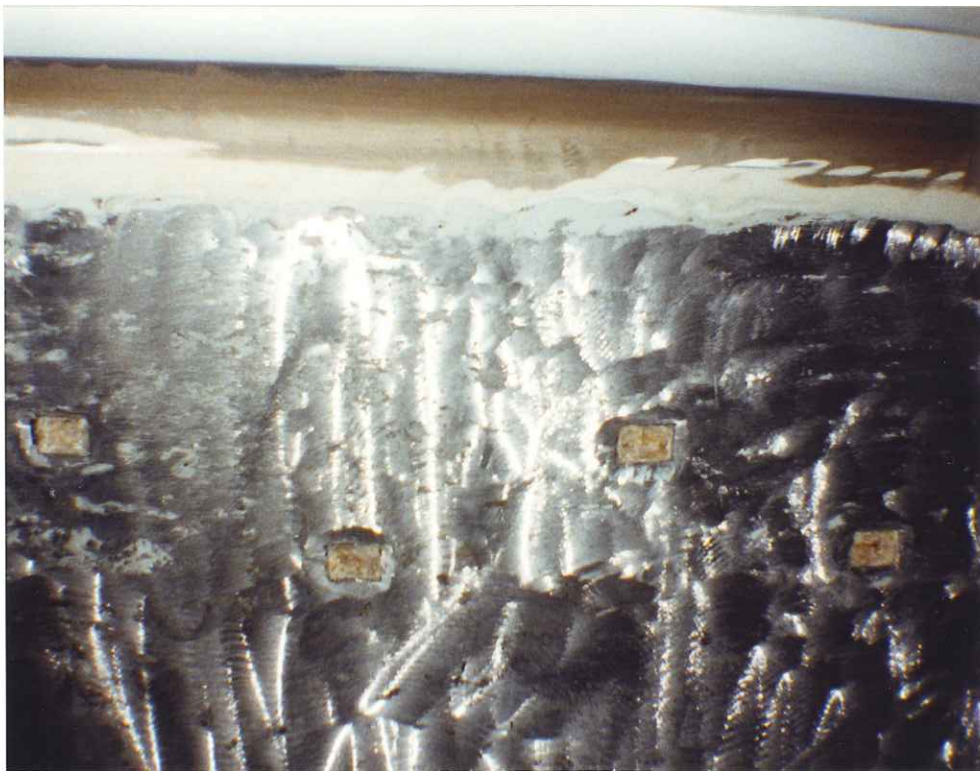
Ballast mit Befestigungslochern für Kielbolzen.
