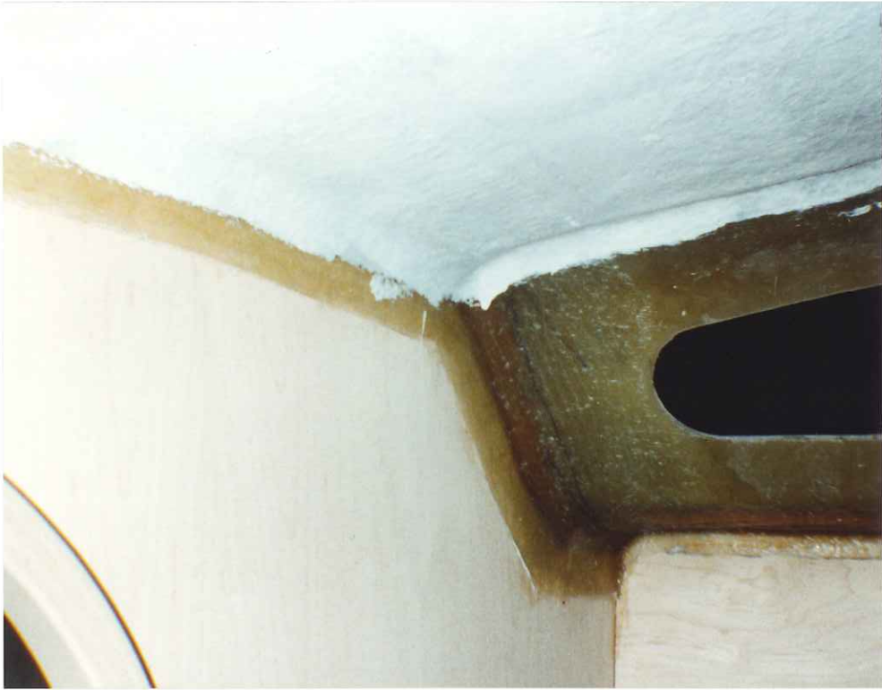
Das Hauptschott wird endgültig aluminisiert.
